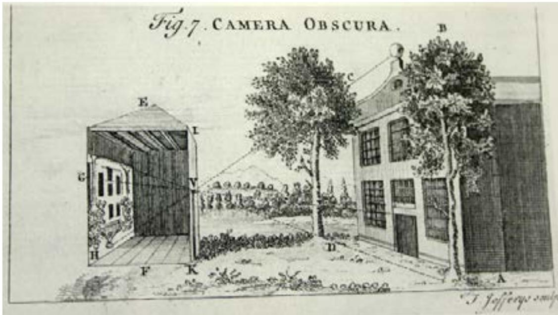
En esta ilustración se puede ver una cámara oscura del tamaño de una casa (E). A través del estenopo (V) se proyecta la imagen de la casa que está al frente de la cámara (B) en la pared opuesta al estenopo de la cámara (H). De esta forma el dibujante podía entrar en esta casa y “calcar” la imagen proyectada de la casa de enfrente.
